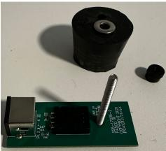
4. Placez la carte de capteur de température et d'humidité à l'intérieur de la pièce supérieure de l'écochambre, sous l'un des trous. Insérez le bouchon à deux trous dans le haut du trou de l'écochambre et passez la longue vis à travers le bouchon. Fixez la carte au bouchon à l'aide de la vis et de la rondelle fournies. Il peut être pratique de raccorder la carte de capteur de température et d'humidité à son câble avant de l'attacher au bouchon.
