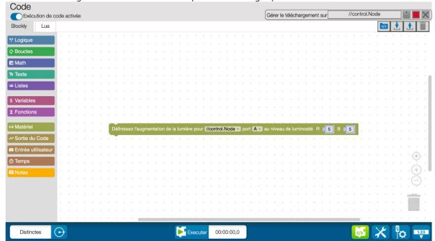
20. Testez le code en appuyant sur le bouton Exécuter. Les lumières clignoteront une fois. Pour que la lumière Grow Light s'allume en permanence, ouvrez l'onglet Boucles et sélectionnez une boucle « tant ».
